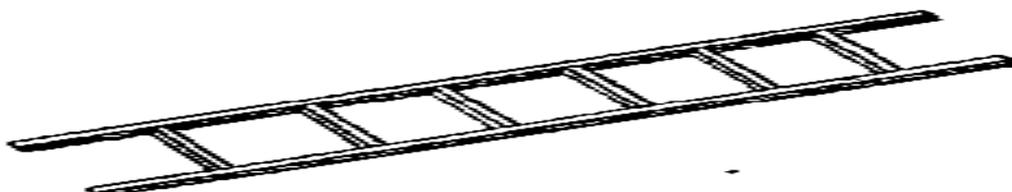
Легкими и удобными являются лестницы, изготовленные из дюралюминиевых трубок. В ряде случаев весьма удобно применять спасательную лестницу с вертикальными стойками и поручнями.
